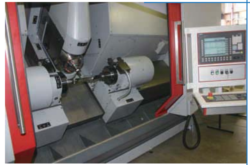
↑ 結合積層製造與CNC的混合機種HSTM 1000整合雷射披覆、切削及探測在同一台工具機內，簡化了供應鏈並有效的提高生產效率。 (Source: Bernard & Company's Blog)
