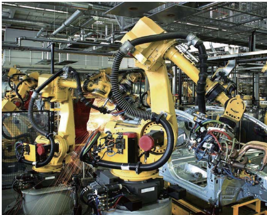
工業機器人目前只能從事部分簡單、重複性高的工作，但卻能夠24小時不間斷的工作，達到「熄燈製造」的可能。(Source: module-r.com)
